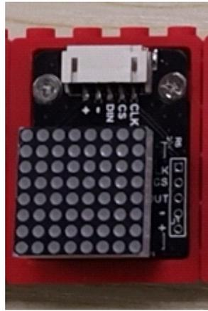
产品详情及参数：MAX7219是一种集成化的串行输入/输出共阴极显示驱动器，它连接微处理器与8位数字的7段数字LED显示，也可以连接条线图显示器或者64个独立的LED。
