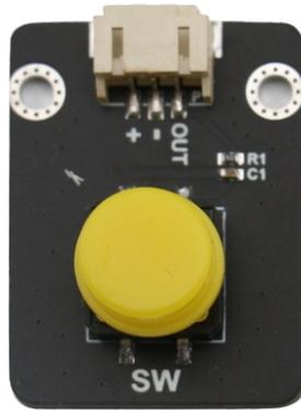
产品详情及参数：按钮是用于控制电子设备的常见组件。他们是通常用作连接或断开电路的开关。在正常情况下，按钮的两个触点处于断开状态，只有按下按钮时它们才闭合。
