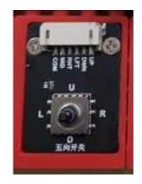
产品详情及参数: 五向开关其最大的不同就是由五个触点。在内底部,有着中央固定触点以及公用触点外壳, 还有就是在其周围有很多周边的固定触点的外壳。这些外壳都放置在活动触点簧片上。当机器想要形成一个通路的时候, 就可以直接让触点簧片和公用触点连接在一起。所述活动触点簧片能够连接在一起, 加上操作杆的控制, 就能够使得它一个活动触点簧片可以直接与其相对应的触点连接起来。
