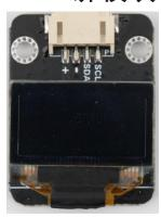
产品详情及参数: OLED(Organic Light-Emitting Diode)又称为有机电激光显示、有机发光半导体(Organic Electroluminesence Display, OLED)。OLED属于一种电流型的有机发光器件,是通过载流子的注入和复合而致发光的现象,发光强度与注入的电流成正比。OLED在电场的作用下,阳极产生的空穴和阴极产生的电子就会发生移动,分别向空穴传输层和电子传输层注入,迁移到发光层。当二者在发光层相遇时,产生能量激子,从而激发发光分子最终产生可见光。一般而言,OLED可按发光材料分为两种: 小分子OLED和高分子OLED(也可称为PLED)。OLED是一种利用多层有机薄膜结构产生电致发光的器件,它很容易制作,而且只需要低的驱动电压,这些主要的特征使得OLED在满足平面显示器的应用上显得非常突出。OLED显示屏比LCD更轻薄、亮度高、功耗低、响应快、清晰度高、柔性好、发光效率高,能满足消费者对显示技术的新需求。
