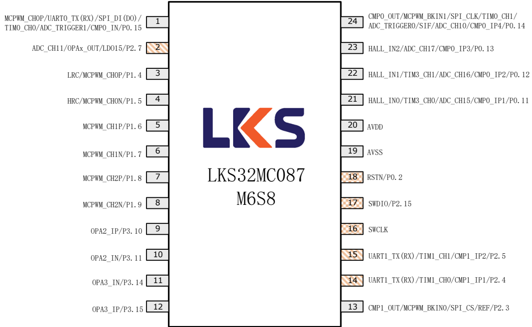
图 3-5 LKS32MC087M6S8 管脚分布图
