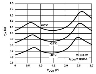
FIGURE 11. ON-RESISTANCE vs SWITCH VOLTAGE
