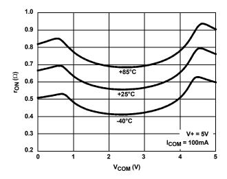
FIGURE 10. ON-RESISTANCE vs SWITCH VOLTAGE
