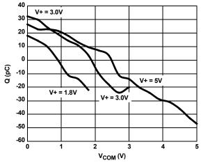
FIGURE 18. CHARGE INJECTION vs SWITCH VOLTAGE
