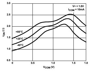
FIGURE 12. ON-RESISTANCE vs SWITCH VOLTAGE
