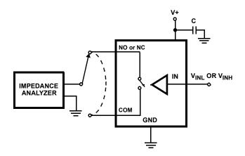
FIGURE 7. CAPACITANCE TEST CIRCUIT
