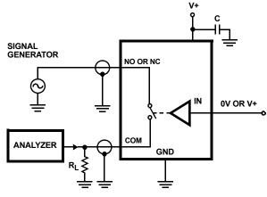
FIGURE 4. OFF ISOLATION TEST CIRCUIT
