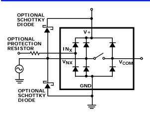
FIGURE 8. OVERVOLTAGE PROTECTION
