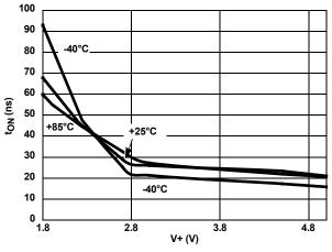
FIGURE 13. TURN-ON TIME vs SUPPLY VOLTAGE
