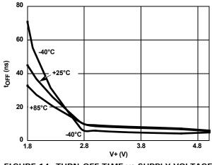
FIGURE 14. TURN-OFF TIME vs SUPPLY VOLTAGE
