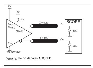
2.5V Core/2.5V LVPECL Output Load Test Circuit
