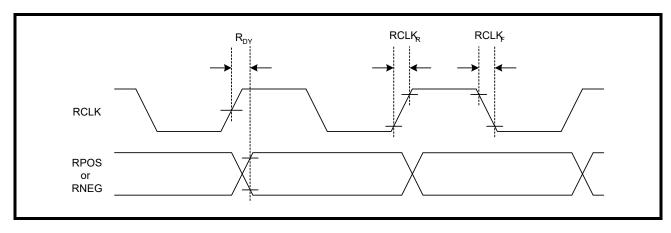
FIGURE 7. RECEIVE DATA UPDATED ON THE FALLING EDGE OF RCLK
