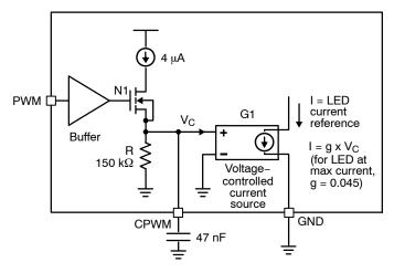
Figure 29. PWM Circuit Block Diagram
