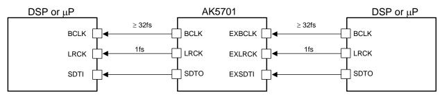
Figure 24. Bypass Mode
