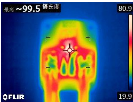
封装体热成像图 (输入电流 40A)
