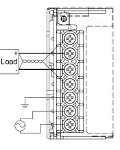
Recommended torque : HWS15A - HWS150A M3.5 screw 1.0N · m(10.2kgf · cm) - 1.6N · m(16.3kgf · cm)
