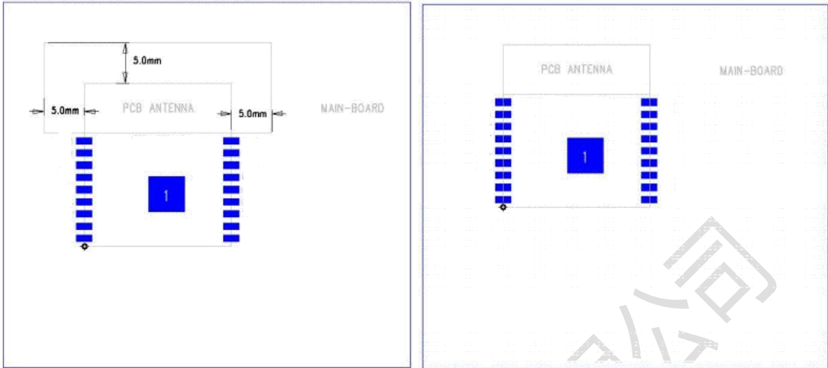
↑方案5: 天线板框内放置且下方挖空
