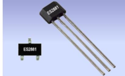
对于 TO-92S 封装，当垂直于霍尔传感器的 S 极磁场超过工作点时，ES2491 输出晶体管变为低电平（输出导通），导通后输出电压是  $V_{DS}$ 。当磁场减弱到低于释放点  $B_{RP}$  时，输出晶体管截止（输出高电平）。磁场工作点与释放点之间的差距为器件的磁滞 ( $B_{HYS}$ )。内置磁滞防止了在转换点附近的输出振荡，而且即使在外部机械振动和电器噪声的情况下也能得到清晰的输出转换。SOT23 封装产品感应极性与 TO-92S 产品相反。
