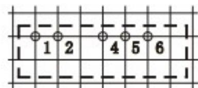
俯视图,栅格间距 2.54mm 开孔直径 1.00mm
