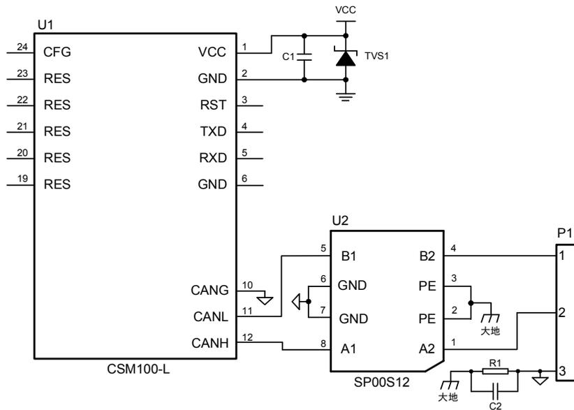
由于模块内部自带 ESD 保护器件，因此当模块应用于现场环境良好的场合时，无需再加端口保护器件。但若应用环境比较恶劣（如高压电力、雷击环境等），则建议用户在模块 CAN 通讯端口外加共模电感、TVS 管、气体放电管等构成端口保护电路。另外，在使用屏蔽双绞线时需要对接屏蔽层可靠接地，建议采用单点接地。推荐应用电路如图 5 (a)、(b) 所示，推荐参数如表 1 所示。
