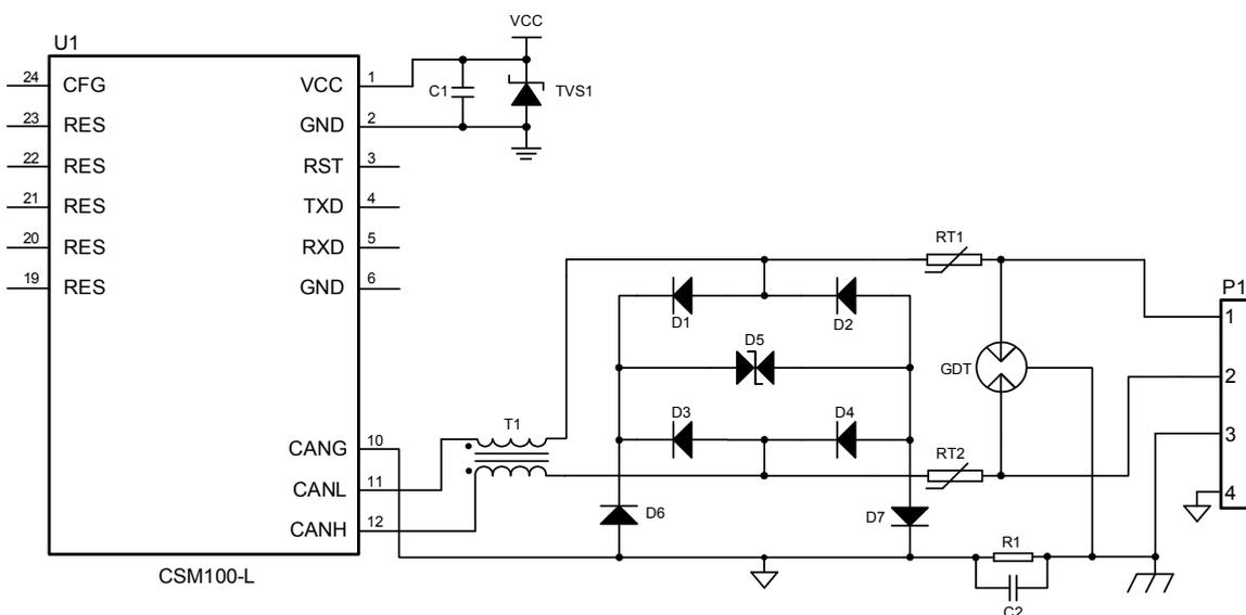
(b) 带 CANG 引脚的端口保护
