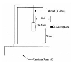
1 METER FROM MICROPHONE TO FAN INTAKE
