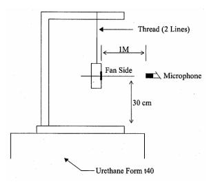
1 METER FROM MICROPHONE TO FAN INTAKE
