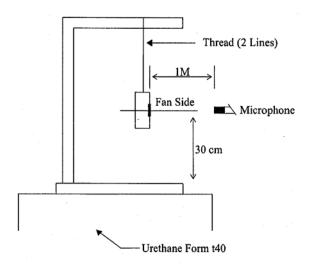
1 METER FROM MICROPHONE TO FAN INTAKE
