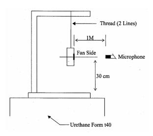
1 METER FROM MICROPHONE TO FAN INTAKE
