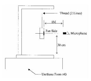
1 METER FROM MICROPHONE TO FAN INTAKE
