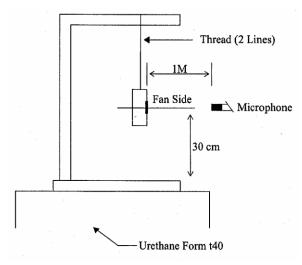
1 METER FROM MICROPHONE TO FAN INTAKE
