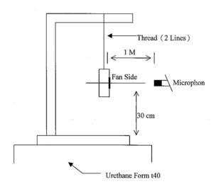
1 METER FROM MICROPHONE TO FAN INTAKE
