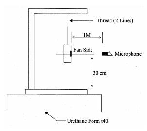
1 METER FROM MICROPHONE TO FAN INTAKE
