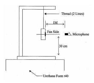
1 METER FROM MICROPHONE TO FAN INTAKE
