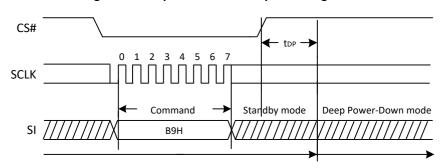
Figure 29. Deep Power-Down Sequence Diagram
