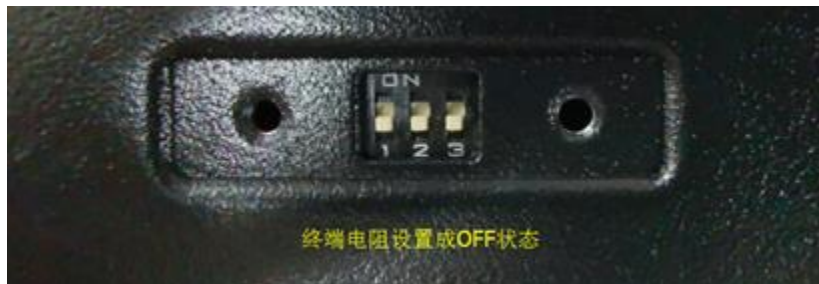
图 2.2 拨码开关使用方法
