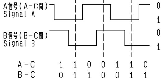
クリック位置より、A 信号が先に変化後、B 信号が変化した時に CW 方向と判定。
