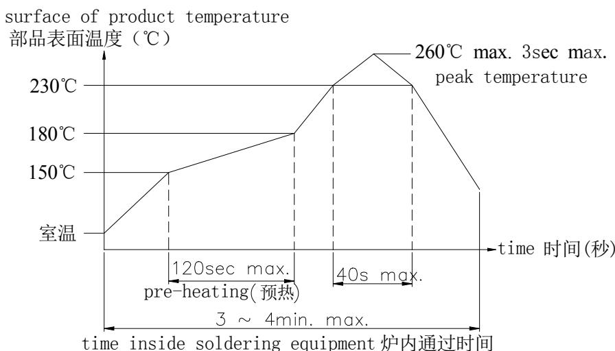
注意: 以上提及的条件是零部件上PWB表面的温度, 由于PWB的材料、尺寸、厚度等不同, PWB从开关表面获得的温度也会有很大差异, 因此, 千万小心不要让开关表面温度超过260°C
