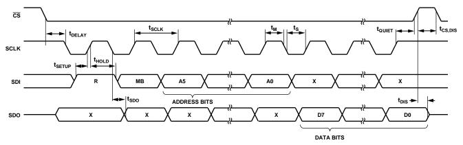
Figure 28. SPI 4-Wire Read
