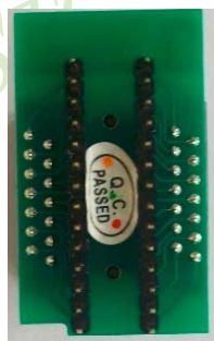
SOP-28和SOP-20的转换座(反面)
