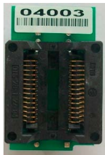
SOP-28和SOP-20的转换座(正面)
