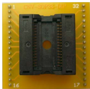
SOP-32的转换座(正面)
