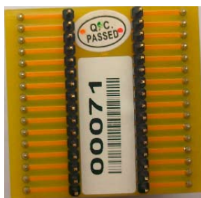
SOP-32的转换座(反面)
