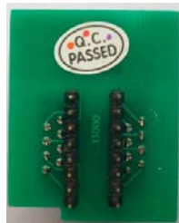
SOP-16和SOP-8的转换座(反面)
