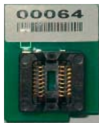
SOP-16和SOP-8的转换座(正面)
