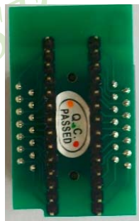
SOP-28和SOP-20的转换座(反面)
