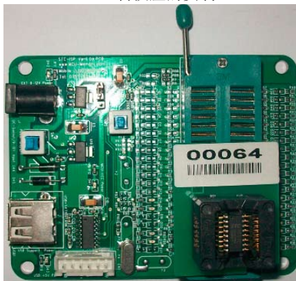
SOP-16转换座的安装
