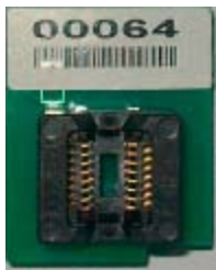
SOP-16和SOP-8的转换座(正面)
