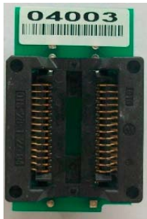
SOP-28和SOP-20的转换座(正面)
