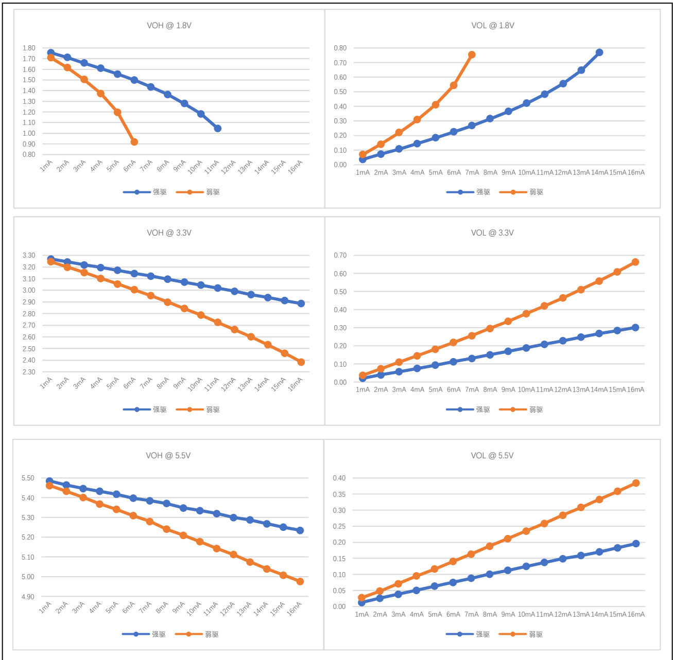
图 7-2 输出端口 VOH/VOL 实测曲线
