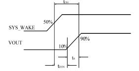
Figure 18. SYS\_WAKE vs.  $V_{\text{OUT}}$
