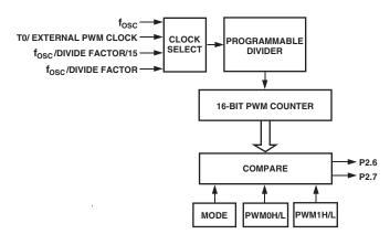
Figure 26. PWM Block Diagram
