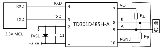
图 2.MCU 3.3V 供电应用电路
