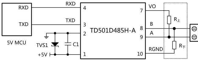
图 1.MCU 5V 供电应用电路
