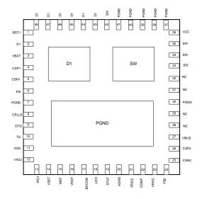
Fig. 3 Pin-Function (QFN6X6-48)
