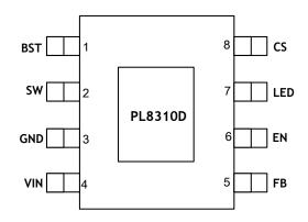
Fig3. PL8310D ESOP-8 Package
