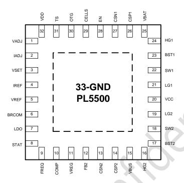
Fig. 2 Pin-Function (QFN4X4-32)
