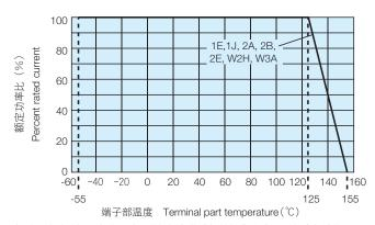
超过上述端子部温度使用时,请根据负荷减轻特性曲线减小额定功率后使用。 ※ 有关使用方法,请参照卷首的"端子部温度负荷减轻特性曲线的说明"。 For resistors operated terminal part temperature of described for each size or above, a power current shall be derated in accordance with derating curve.
