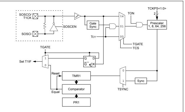
**16-BIT TIMER1 MODULE BLOCK DIAGRAM**
