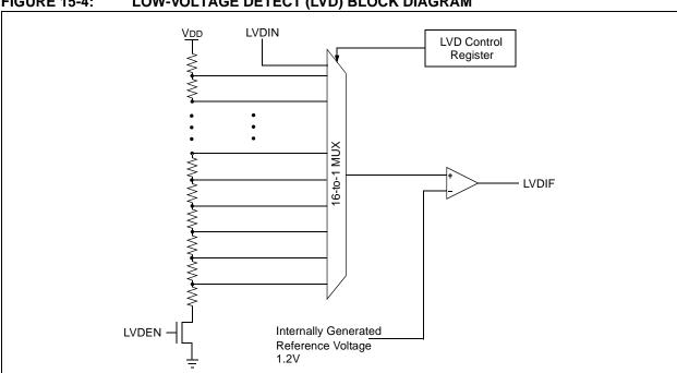
**FIGURE 15-4:** LOW-VOLTAGE DETECT (LVD) BLOCK DIAGRAM
