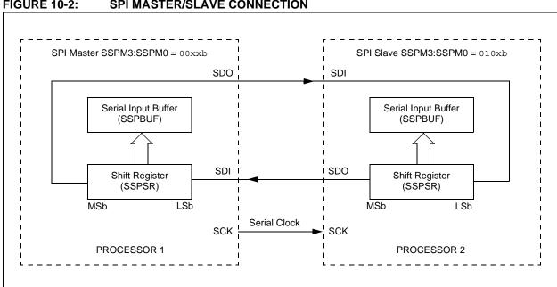
**FIGURE 10-2:** SPI MASTER/SLAVE CONNECTION
