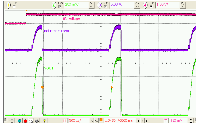
图 33. 启动持续到负载出现故障, V_{OUT} = 0.9\text{ V}
