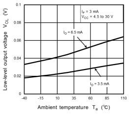
Fig. 13.2.5 V<sub>OL</sub> - T<sub>a</sub>
