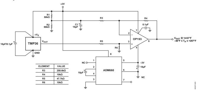
Figure 27. TMP36 Fahrenheit Thermometer Version 2
