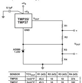
Figure 25. TMP35/TMP37 Fahrenheit Thermometers
