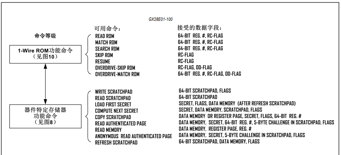
图 2. 1-Wire 协议层次结构
