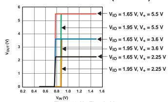
Figure 13.  $V_{\rm IO}$  Thresholds
