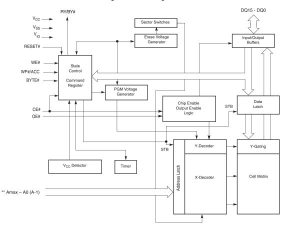
Figure 1. Block Diagram<sup>[1]</sup>
