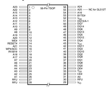
Figure 34. 56-Pin Standard TSOP<sup>[170]</sup>
