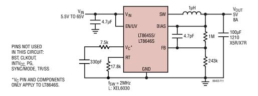
Figure 11. 2MHz 5V, 8A Step-Down Converter
