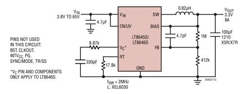
Figure 12. 2MHz 3.3V, 8A Step-Down Converter
