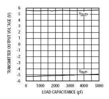
TRANSMITTER OUTPUT VOLTAGE vs. LOAD CAPACITANCE
